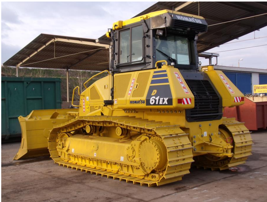
Komatsu D61 EX dózer a depónia művelését szolgálja.
